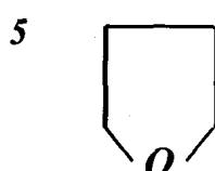
A.2.10 Все знаки химической связи в циклических соединениях должны вплотную подходить к циклам.
